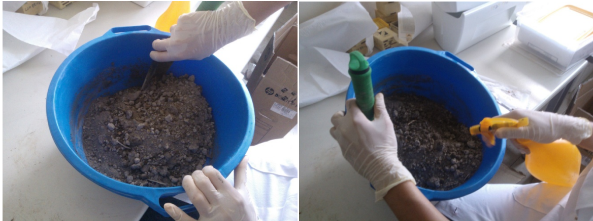
Fig.2. Fase di reidratazione dei terreni
